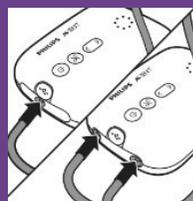
6. Fixez les tubes aux moteurs, branchez l'adaptateur sur la prise secteur et insérez la prise à l'autre extrémité dans le bloc moteur.
