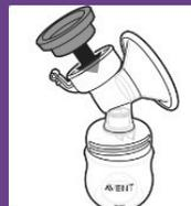
5. Placez le diaphragme en silicone dans le corps du tire-lait. Assurez-vous que le diaphragme couvre parfaitement le bord en appuyant doucement dessus avec vos pouces.
